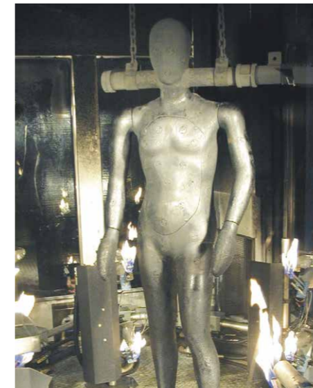
デュポン™ サーモマン® 試験は、デュポン社の技術者がより優れた防護服を開発することに貢献しています。
