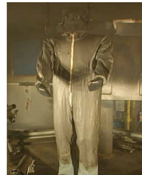
タイケム® 6000 FR を着用させた場合、同様の火炎へのばく露後、製品は発火・延焼などせず、防護性が維持され火傷は最小限に抑えられます。(写真は発火源を取り除いてから3秒後の状態)
