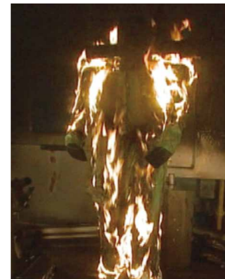
難燃性のない一般的な化学防護服を着用させた場合、火災ばく露を受けると、製品が発火・延焼・溶滴してマネキン表面に落ち、結果的に重度の火傷を引き起こすことが予測されます。(写真は発火源を取り除いてから3秒後の状態)
