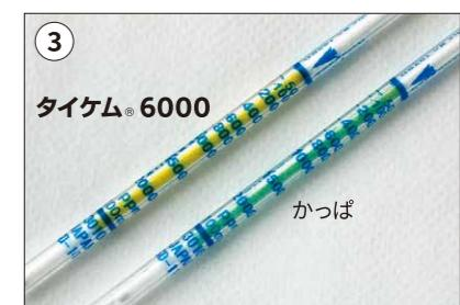
タイケム® 6000側の検知管に変化はないが、かっぽ側の検知管が変色しているのがわかる。
