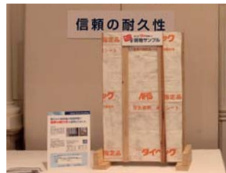
展示コーナーでは18年経過したタイベック・ハウスラップのサンプルをご紹介します。
